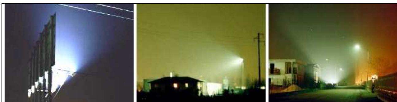
Fig.1 - Tipici esempi di dispersione di luce ingiustificata verso il cielo o dove non richiesta
