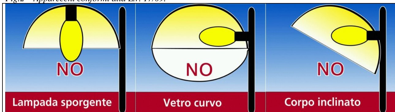
Fig.3 – Apparecchi che per configurazione non sono conformi alla L.r. 17/09.
