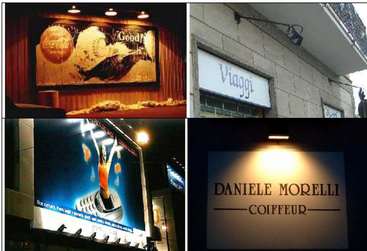
Fig.23 – Alto-Destra: insegna di esercizio che non necessita né di progetto né di autorizzazione del sindaco per la LR17/00, deve comunque avere emissione di 0cd/klm a 90° ed oltre. In questo caso, l'inclinazione poco consona alla LR17/00 potrebbe comunque essere compensata dallo schermo naturale del terrazzo (da verificare in fase di installazione).
