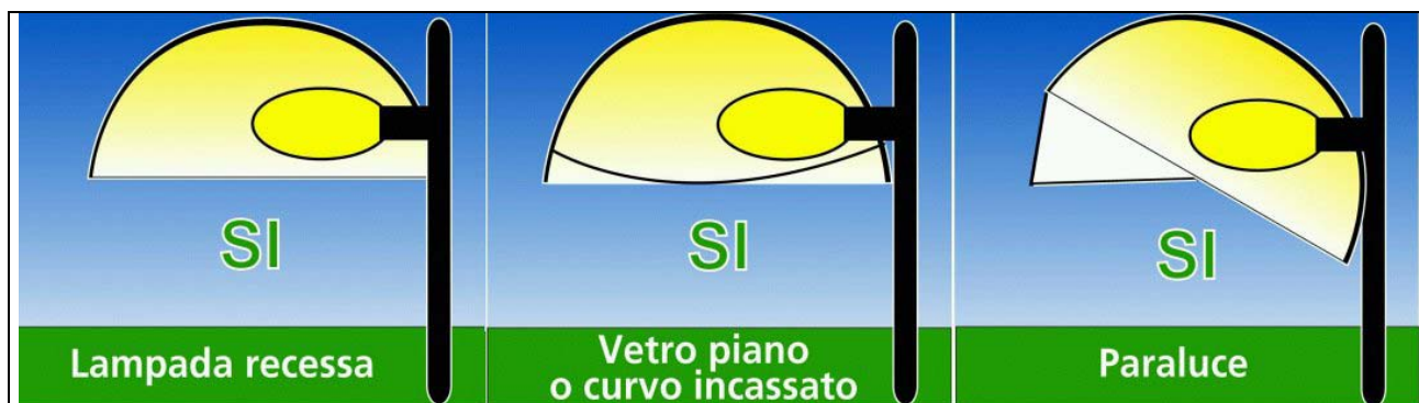
Fig.6 – (in alto) Apparecchi che per configurazione non sono conformi alla LR17/00. (in basso) Alcuni degli aspetti che possono caratterizzare la conformazione degli apparecchi che soddisfano la L.R.17/00
