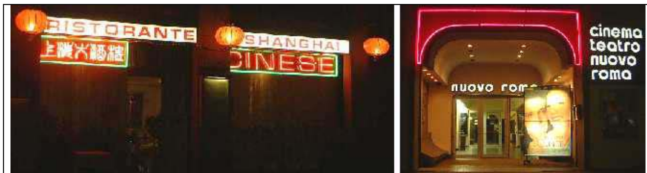
Fig.25 – Alcuni tipi di insegne derogate dalla legge e per le quali la legge richiede solamente lo spegnimento dopo le 23 o all'orario di chiusura dell'esercizio. Si vedono: lettere scatolate con illuminazione propria (la scritta cinema), neon nudi (decorazione ingresso al cinema e scritta in cinese), o pannelli ad illuminazione interna (le scritte ristorante e la locandina del cinema).
