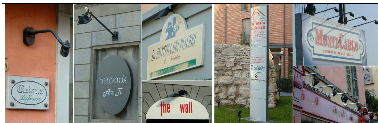
Fig.16 – Esempi di insegne prive di illuminazione propria. Le 4 illuminazioni delle insegne sulla sinistra sono conformi alla LR17/00 in quanto eseguite dall'alto verso il basso con corpi illuminanti orizzontali o inclinati in modo tale che il fascio di luce viene comunque intercettato almeno dalla parete che ospita l'insegna. Nelle 3 illustrazioni di destra le insegne sono illuminate in modo non conforme alla LR17/00 e rispettivamente: l'insegna a colonna è illuminata dal basso, il pannello pubblicitario è illuminato dall'alto ma con corpi illuminanti inclinati e tali da inviare luce fuori dalla sagoma e verso il cielo. Infine, nella terza immagine, l'insegna di un pub viene illuminata con apparecchi verticali e paralleli all'insegna con dispersione di luce anche oltre la sagoma dell'edificio e verso l'alto..
