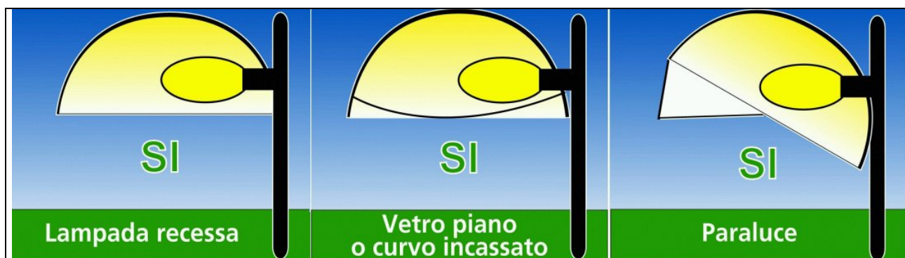
Fig.2 – Apparecchi conformi alla LR15/05.
