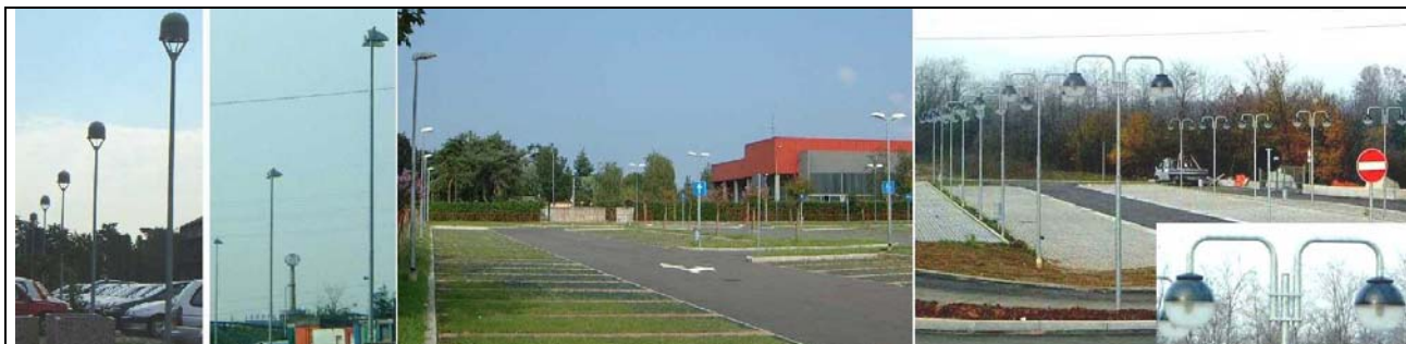
Fig. 2.2 – I primi tre parcheggi (conformi alla LR 15/05) sono realizzati rispettivamente con apparecchi da arredo urbano, riflettori asimmetrici, apparecchi stradali. Nell'immagine a destra appare invece un parcheggio realizzato con sfere solo in parte schermate non conformi alla LR 15/05
