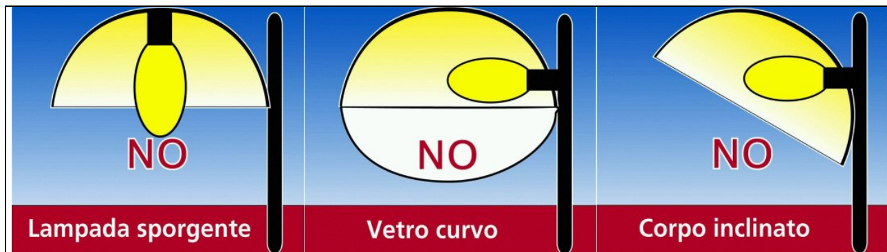
Fig.4 –Apparecchi che per configurazione non sono conformi alla LR15/05.
