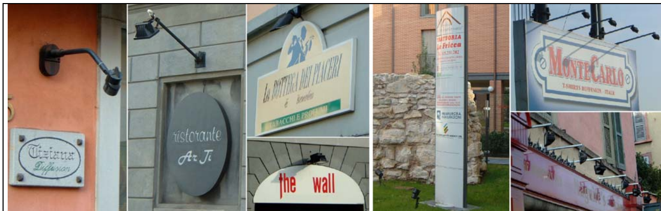
Fig.17 – Esempi di insegne prive di illuminazione propria. Le 4 illuminazioni delle insegne sulla sinistra sono conformi alla LR15/05 in quanto eseguite dall'alto verso il basso con corpi illuminanti orizzontali o inclinati in modo tale che il fascio di luce viene comunque intercettato almeno dalla parete che ospita l'insegna. Nelle 3 illustrazioni di destra le insegne sono illuminate in modo non conforme alla LR15/05 e rispettivamente: l'insegna a colonna è illuminata dal basso, il pannello pubblicitario è illuminato dall'alto ma con corpi illuminanti inclinati e tali da inviare luce fuori dalla sagoma e verso il cielo. Infine, nella terza immagine, l'insegna di un pub viene illuminata con apparecchi verticali e paralleli all'insegna con dispersione di luce anche oltre la sagoma dell'edificio e verso l'alto..
