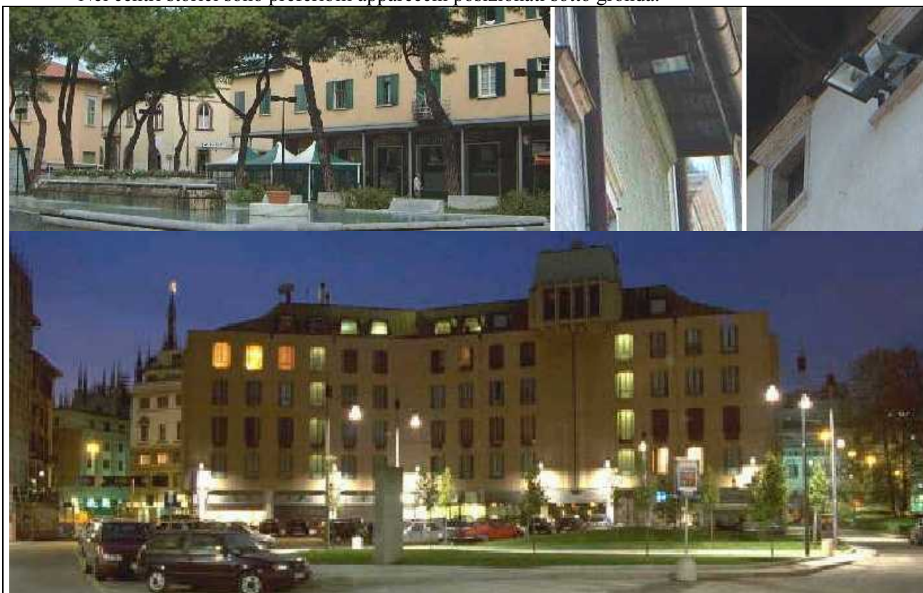
Fig.4.16 – (Nella foto di sinistra) Piazza del comune di Dalmine. Illuminazione conforme alla LR 15/05 e sorgenti luminose poste in modo da non interferire con la chioma degli alberi.
