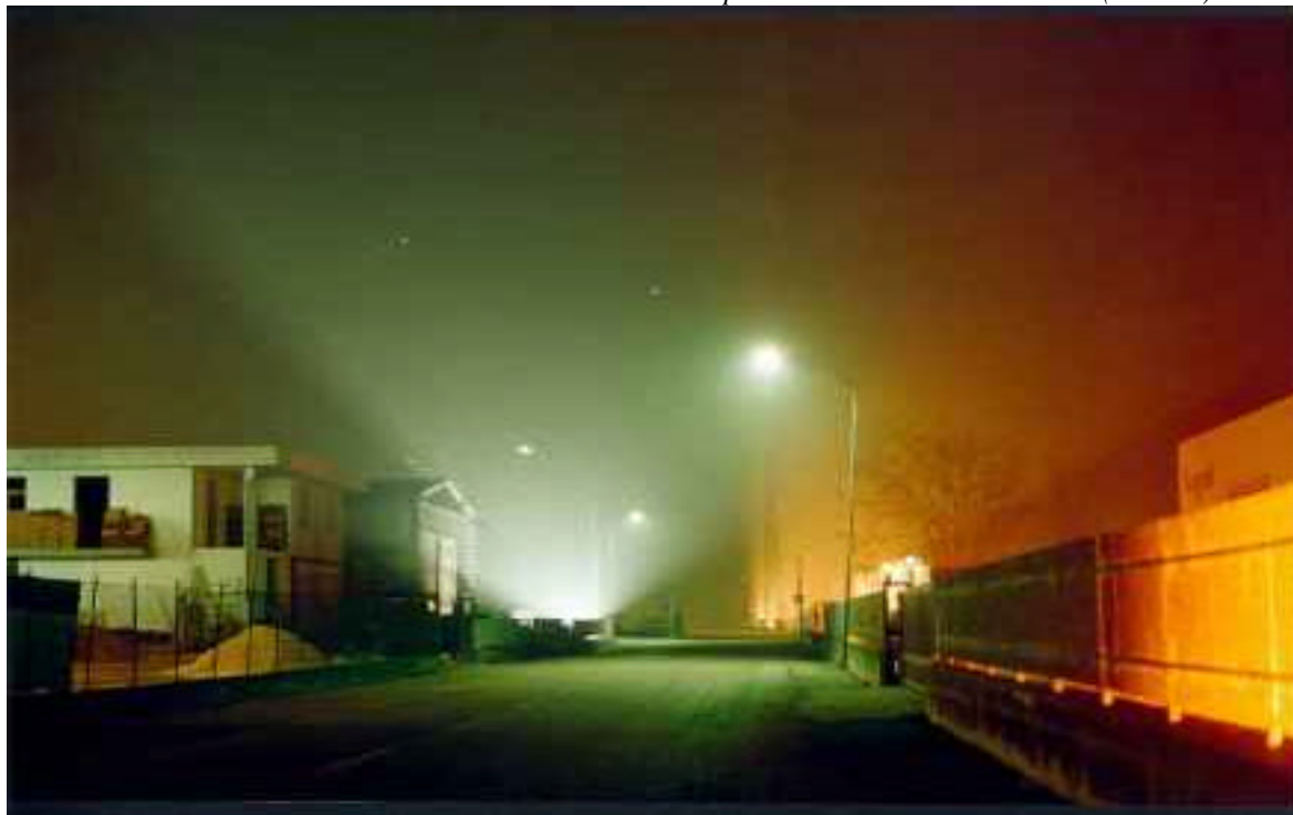
Lonigo (VI) - Zona industriale, Illuminazione delle facciate degli stabilimenti con riflettori simmetrici posti a terra rivolti verso l'alto (E.Rossi).
