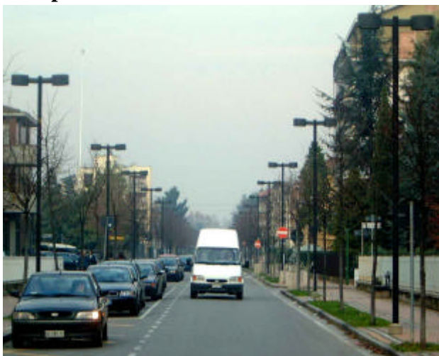
Dalmine - Impianto di Illuminazione stradale full cut-off nei pressi di Bergamo, con una razionale distribuzione dei corpi illuminanti (D.Bonata).
