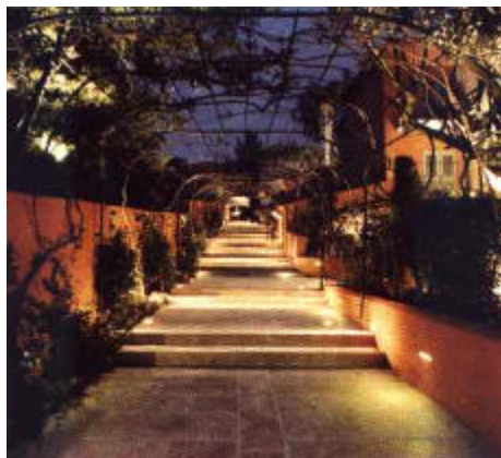
I Segnapasso, inseriti in muri e terreno, se non del tipo schermato disperdono il loro flusso verso l'alto e se numerosi e potenti sono piuttosto inquinanti.
